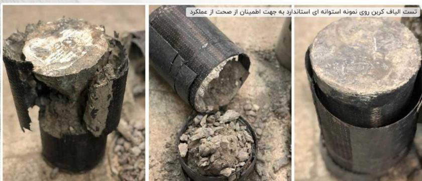
تست الیاف کربن روی نمونه استوانه ای استاندارد به جهت اطمینان از صحت از عملکرد
